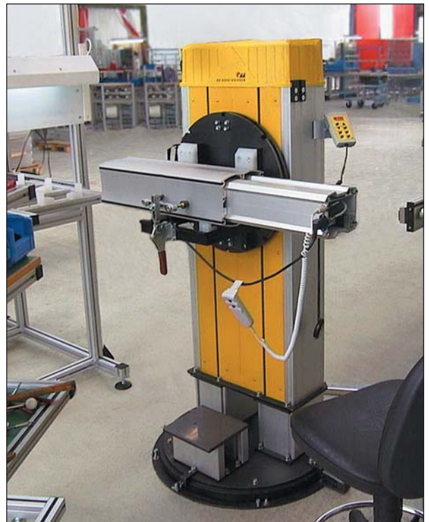
Höhenverstellbarer Montagearbeitsplatz. RK Easylift in Sonderausführung (Fuß und Werkstückaufnahme). Height adjustable assembly work station. Special version of Easylift (pedestal and workpiece holder).
